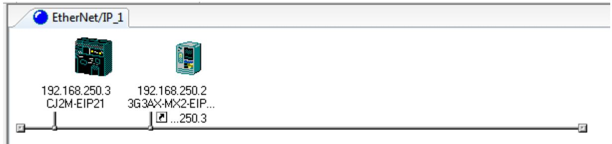
Network Configurator'deki Ethernet/IP ağında gözükten iki cihaz için şu işlemler yapılır: 3G3MX2-AX-MX2 cihazı sürüklenip CJ2M-EIP21 üzerine bırakılır.
